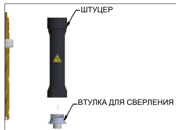
Рисунок 3-5. Установка втулки штуцера
