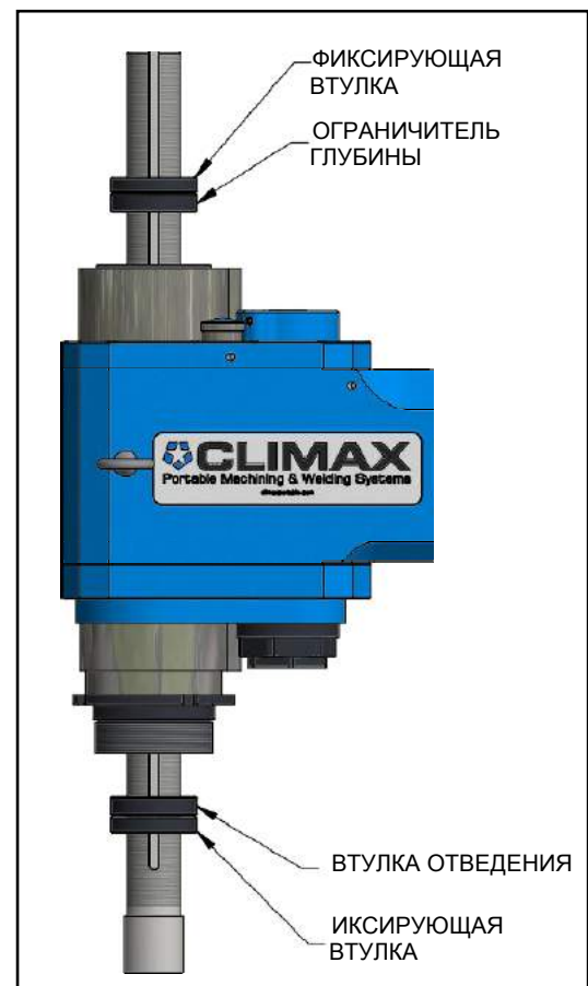
Рис. 3-2. ОГРАНИЧИТЕЛЬ ГЛУБИНЫ И ФИКСИРУЮЩАЯ ВТУЛКА
