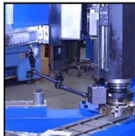
**Рис. 3-56. Установленный циферблатный индикатор**
