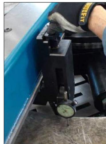
**Рис. 3-28. РАСПОЛОЖЕНИЕ ЦИФЕРБЛАТНОГО ИНДИКАТОРА**
