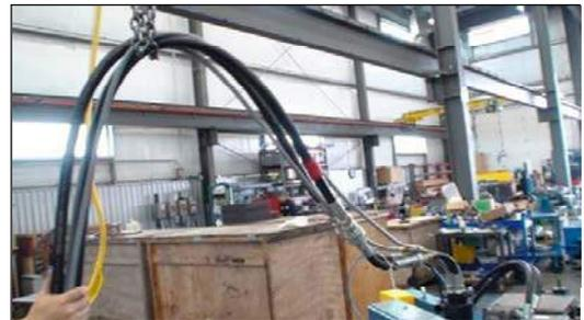
**Рис. 4-1. ПРИМЕР ЗАКРЕПЛЕНИЯ ШЛАНГОВ**
