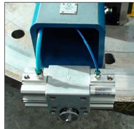
**Рис. 3-30. Линии подачи воздуха коробки подач**
