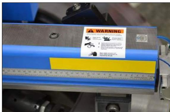
**Рис. 3-19. Линейка рычага мехобработки**
