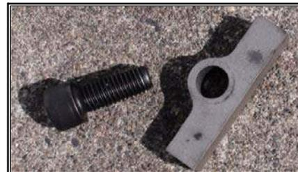
**Рис. 3-3. ПРЕДОХРАНИТЕЛЬНЫЕ СВАРНЫЕ ПЛИТЫ**
