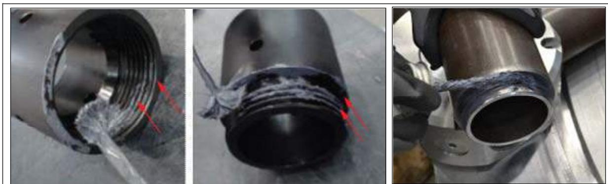
Рис. 3-26. Зоны нанесения противозадирной смазки
