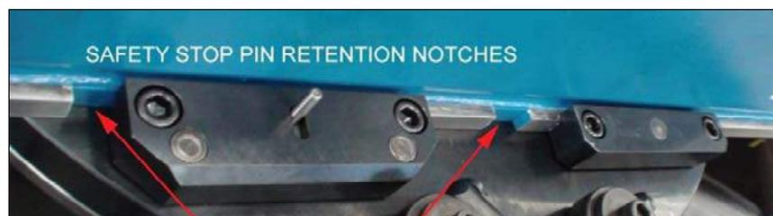
**Рис. 3-17. ПАЗЫ ФИКСАЦИИ ПРЕДОХРАНИТЕЛЬНОГО СТОПОРНОГО ШТИФТА**
