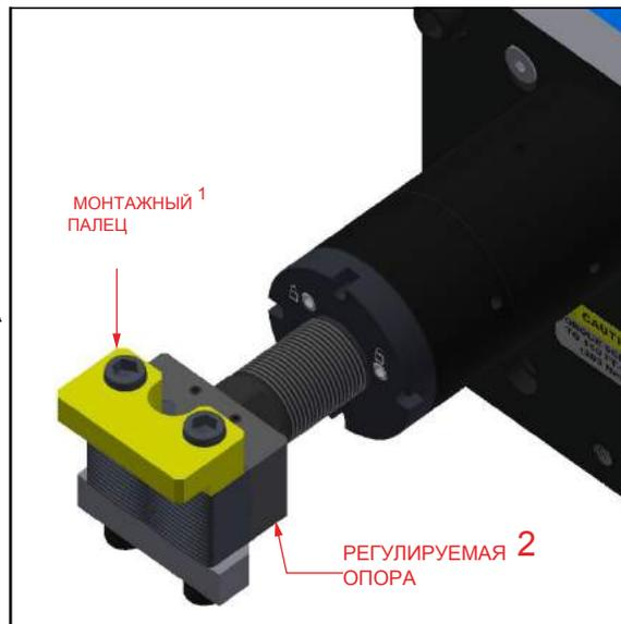
**Рис. 3-27. РЕГУЛИРУЕМАЯ ОПОРА И МОНТАЖНЫЙ ПАЛЕЦ**
