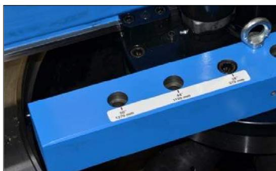
**Рис. 3-21. Крепления противовеса**
