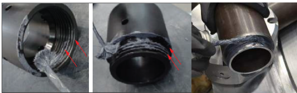
Рисунок 12. Точки нанесения противозадирной смазки
