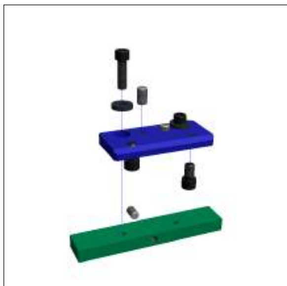
Рисунок 17. Детализовка комплекта для поверхностной установки
