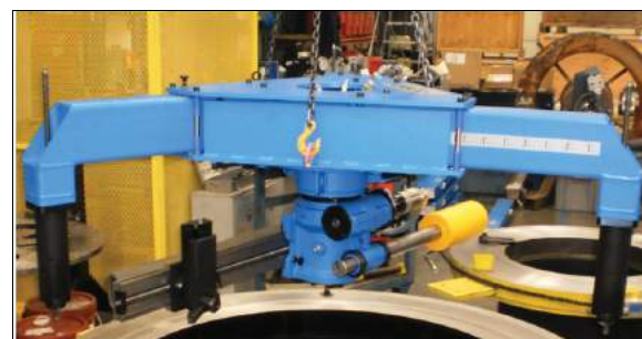
РИСУНОК 3-19. УЗЕЛ КРЕПЛЕНИЯ НА НАРУЖНОМ ДИАМЕТРЕ В СБОРЕ
