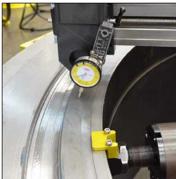
РИСУНОК 3-6. ВЫРАВНИВАНИЕ И ЦЕНТРОВКА ПАТРОНА ДЛЯ ЗАЖИМА НА ВНУТРЕННЕМ ДИАМЕТРЕ
