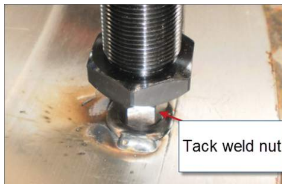
РИСУНОК 3-22. ПРИСОЕДИНЕНИЕ УЗЛА КРЕПЛЕНИЯ НА НАРУЖНОМ ДИАМЕТРЕ С ПОМОЩЬЮ ПРИХВАЧЕННОЙ СВАРКОЙ ГАЙКИ
