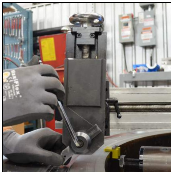
РИСУНОК 3-7. УСТАНОВКА ВСТАВНОГО РЕЗЦА
