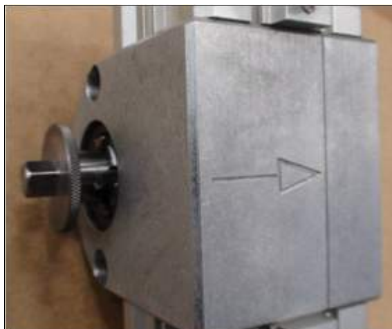
РИСУНОК 3-39. МЕСТОПОЛОЖЕНИЕ СТРЕЛКИ НАПРАВЛЕНИЯ КОРОБКИ ПОДАЧ
