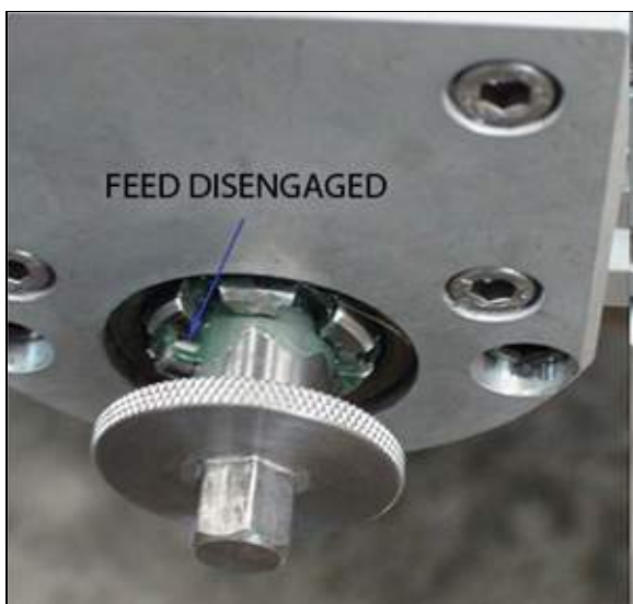
Рисунок 3-33. Положения КОРОБКИ ПОДАЧ
