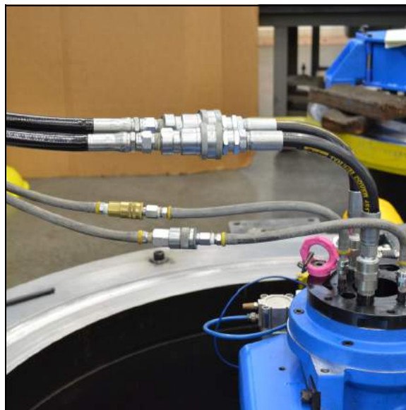
РИСУНОК 3-8. ПОДСОЕДИНЕНИЕ ШЛАНГОВ (ГИДРАВЛИЧЕСКАЯ ВЕРСИЯ)
