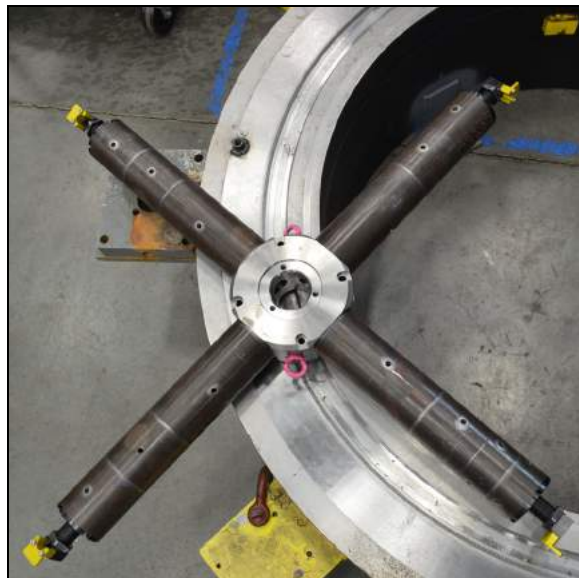
РИСУНОК 3-3. СБОРКА ПАТРОНА ДЛЯ ЗАЖИМА НА ВНУТРЕННЕМ ДИАМЕТРЕ
