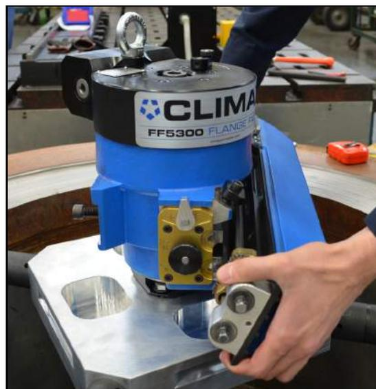
**Рисунок 3-9. Установка ОБРАБАТЫВАЮЩЕГО РЫЧАГА**
