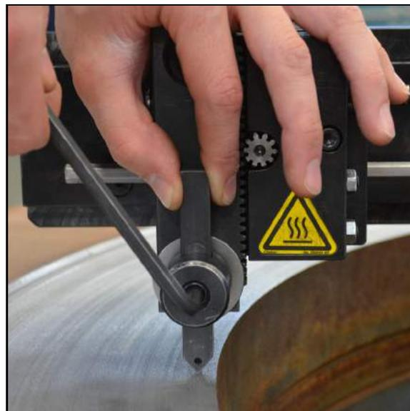
РИСУНОК 3-20. УСТАНОВКА РЕЗЦА
