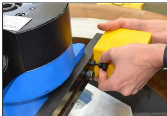
**Рисунок 3-11. Стопорный плунжер в рычаге
