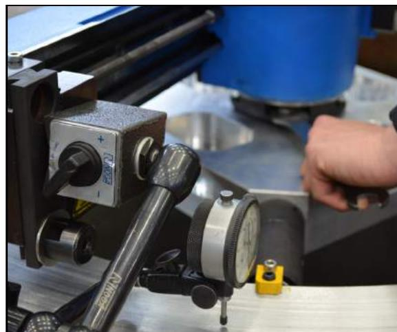
**РИСУНОК 3-17. УСТАНОВЛЕННЫЙ ЦИФЕРБЛАТНЫЙ ИНДИКАТОР**
