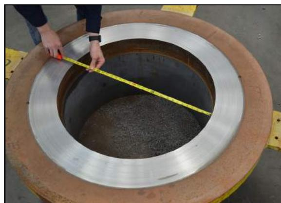
РИСУНОК 3-3. ИЗМЕРЕНИЕ ДИАМЕТРА ОТВЕРСТИЯ
