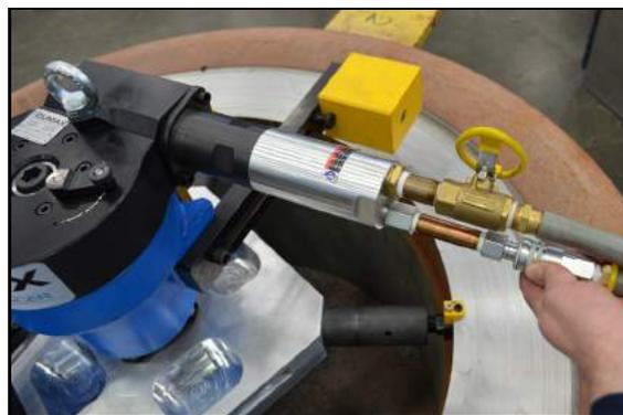
Рисунок 3-23. Подсоединение ПНЕВМОШЛАНГА
