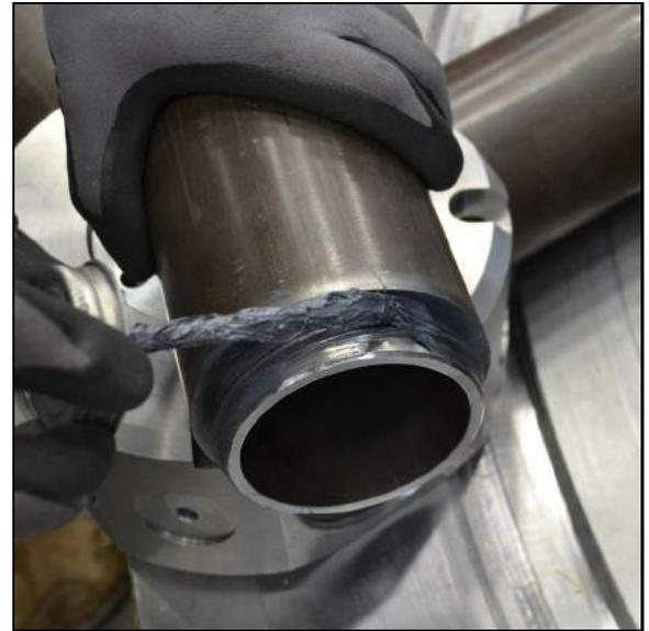
**РИСУНОК 3-5. НАНЕСЕНИЕ ПРОТИВОЗАДИРНОГО СОСТАВА**
