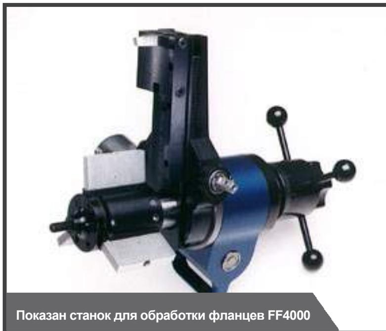
Показан станок для обработки фланцев FF4000
