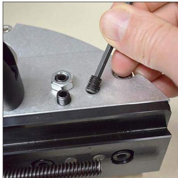
**Рис. 3-34. Снятие винта заглушки (ПОКАЗАНА МОДЕЛЬ FF1200)**
