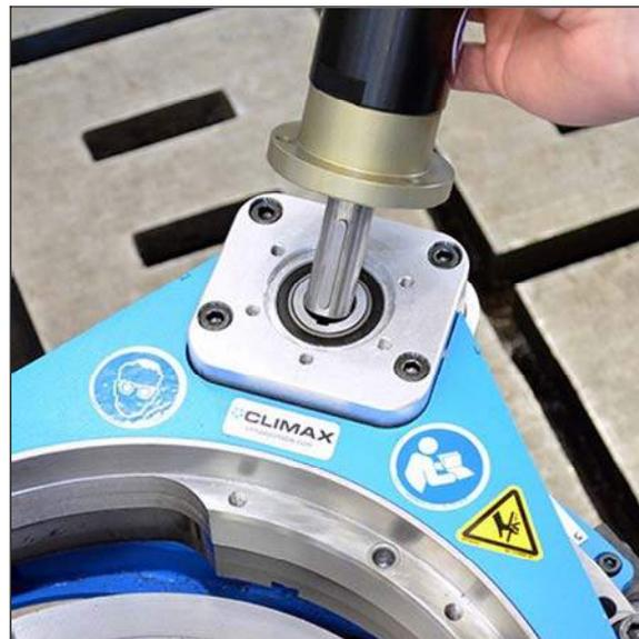
**РИСУНОК 3-24. ЦЕНТРИРОВАНИЕ ПНЕВМАТИЧЕСКОГО ДВИГАТЕЛЯ (ПОКАЗАНА МОДЕЛЬ FF1200)**
