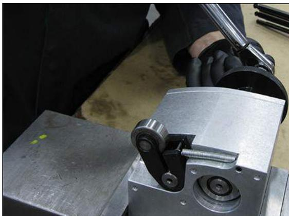
**Рис. 5-4. Установка правильного усилия затяжки на кулачковом рычаге**
