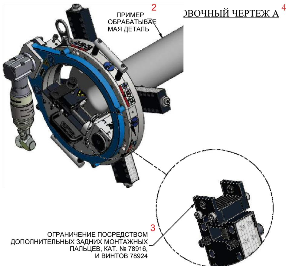
**Рисунок 3-12. ПРИМЕР ВЕРТИКАЛЬНОЙ УСТАНОВКИ С МОНТАЖНЫМИ ПАЛЬЦАМИ**
