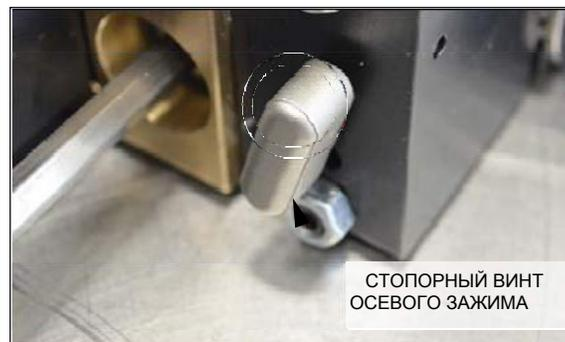
**Рис. 4-3. Стопорный винт осевого зажима (показана модель FF1200)**
