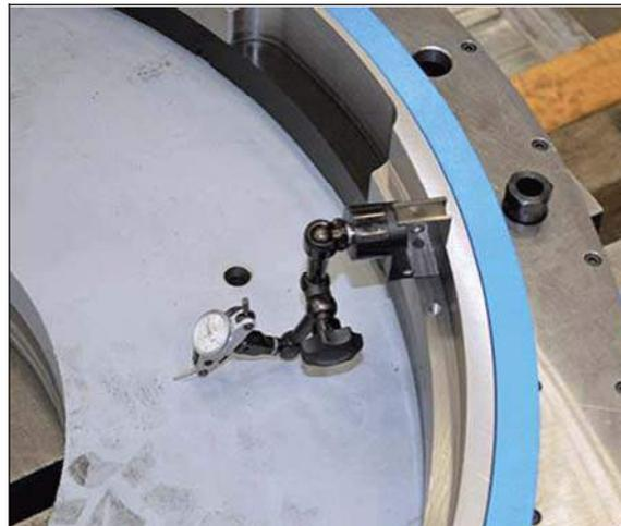
**Рис. 3-17. ВЫРАВНИВАНИЕ УЗЛА ПОВОРОТНОГО ПРИВОДА (ПОКАЗАНА МОДЕЛЬ FF3600)**
