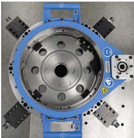
**Рисунок 3-10. УСТАНОВКА ПАТРОНА НА ДЕТАЛЬ (ПОКАЗАНА МОДЕЛЬ FF1200)**
