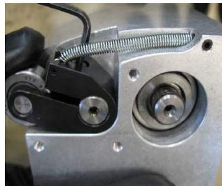
Рис. 5-2. Винт зажима кулачкового рычага
