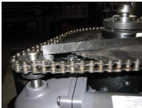
Рис. 17. Регулировка приводной цепи
