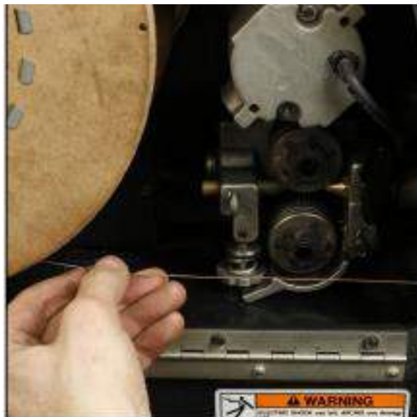
РИСУНОК 3-28. ПРОВОЛОКА ВЫПРЯМЛЕНА ПЕРЕД ПОДАЧЕЙ
