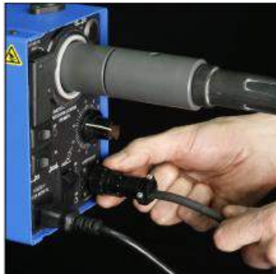
РИСУНОК 3-25. КАБЕЛЬ УПРАВЛЕНИЯ ПОДАЧЕЙ ПРОВОЛОКИ ПОДКЛЮЧЕН
